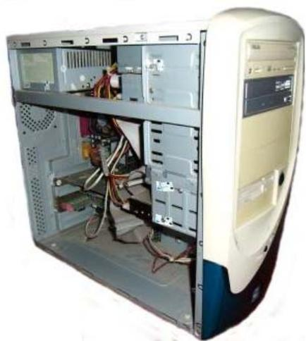
Рис. 2.15. Системный блок
