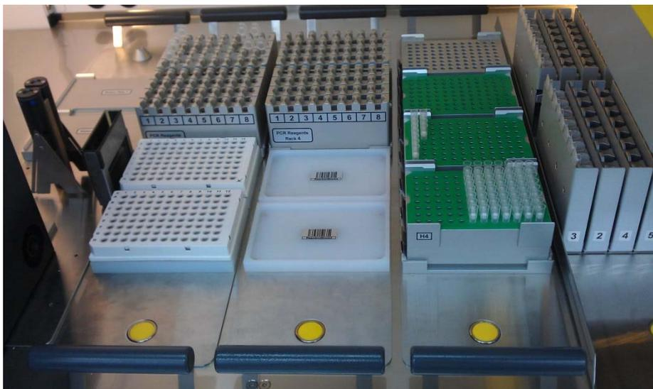
**Рис. 8.3.** Автоматическое управление роботизированной станцией для приготовления реакционных смесей
