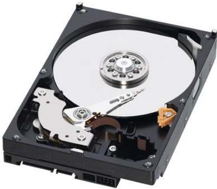
Рис. 2.21. Винчестер со снятой крышкой
