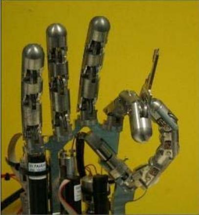
Рис. 7.12. Биоуправляемый протез с тактильными датчиками
