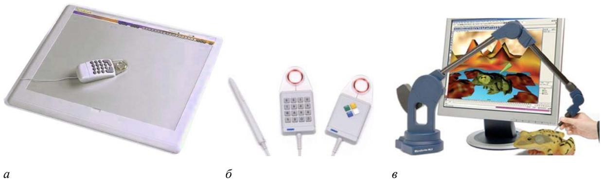
Рис. 2.29. Дигитайзер: а — планшет; б — карандаш и визиры; в — 3D-дигитайзер
