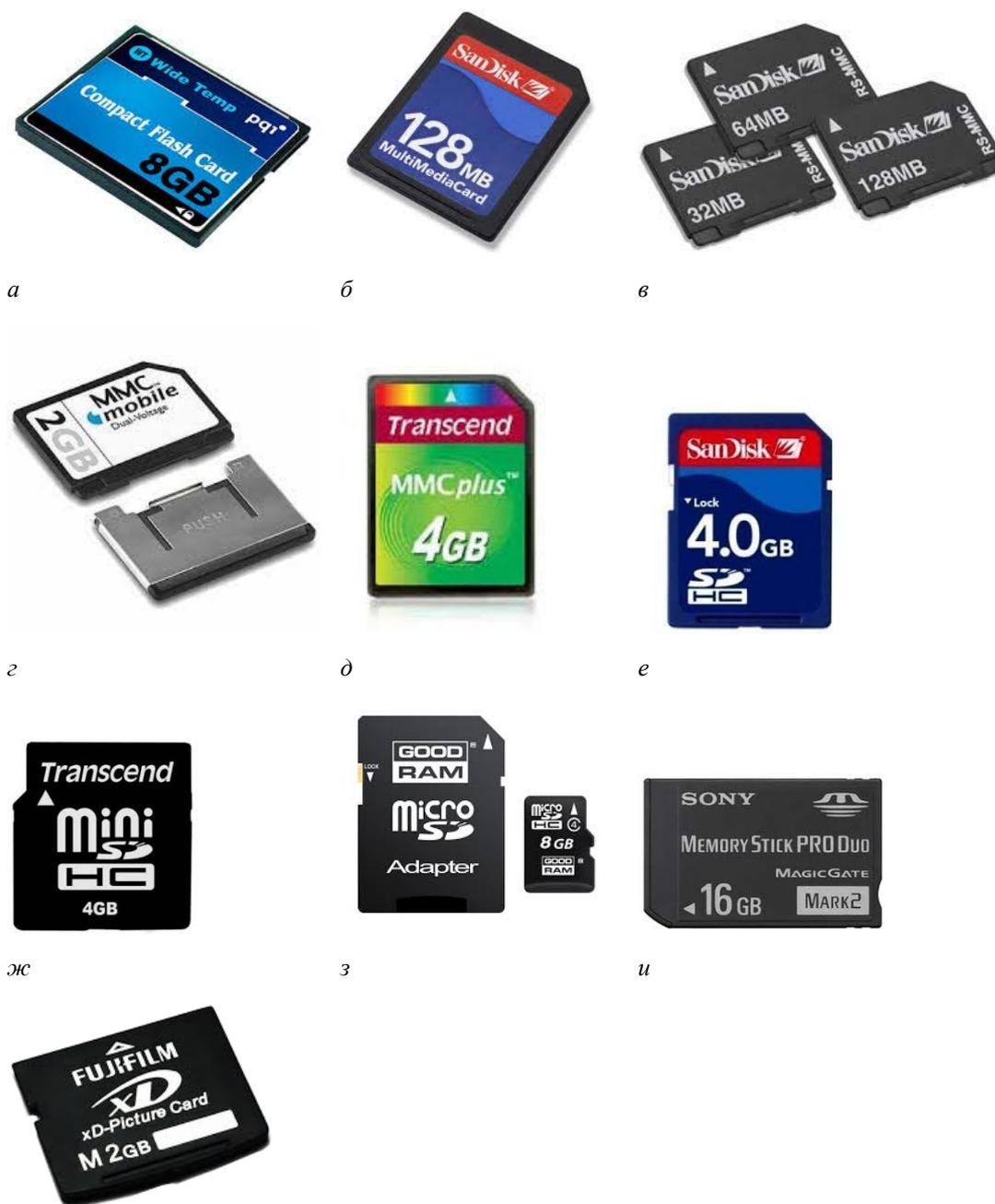
**Рис. 2.24.** Карты флеш-памяти: *а* — Compact Flash; *б* — Multi Media Card; *в* — Redused Size Multi Media Card; *г* — Multi Media Card Mobile; *д* — Multi Media Card Plus; *е* — Secure Digital; *ж* — Mini Secure Digital; *з* — Micro Secure Digital с адаптером; *и* — Memory Stick PRO Duo; *к* — xD Picture Card
