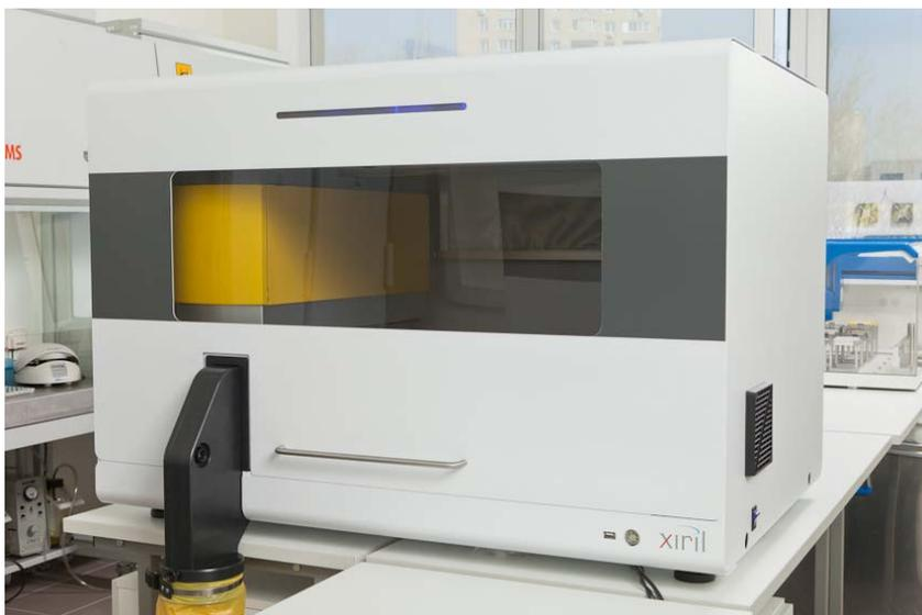
**Рис. 8.2.** Внешний вид ЛИС. Роботизированная станция Neon (Sias, Швейцария)
