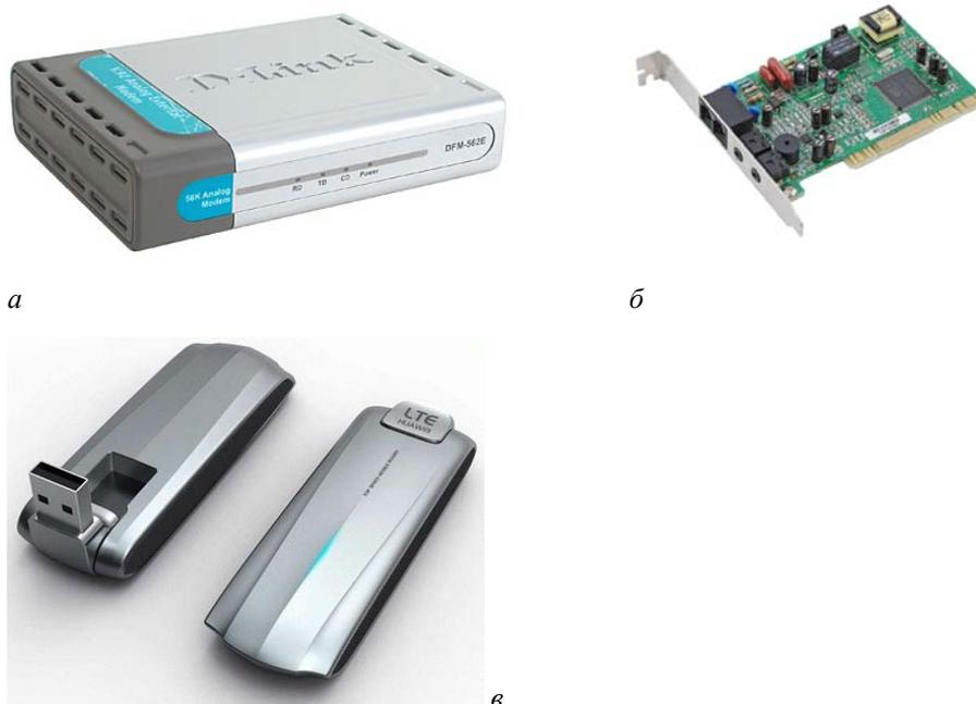
Рис. 2.35. Модем: а — внешний; б — внутренний; в — сотовый
