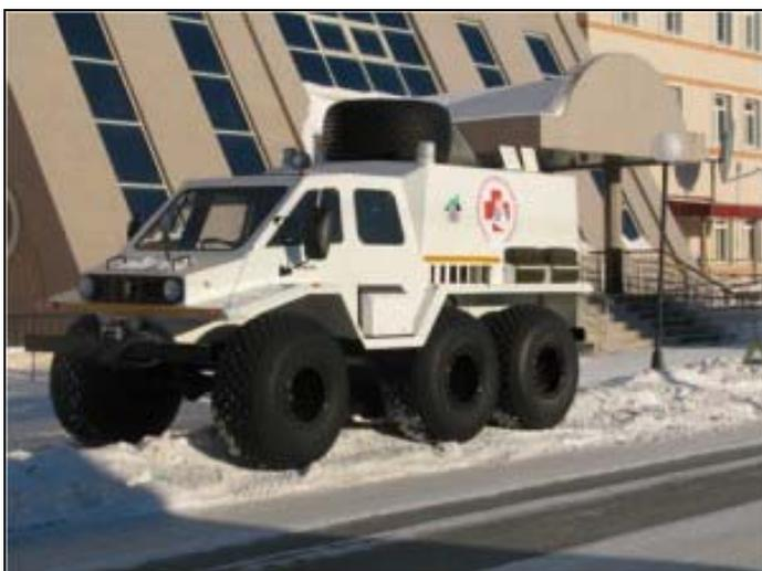
**Рис. 10.12.** Мобильный телемедицинский комплекс на базе вездехода (Окружная больница ЯНАО, г. Салехард)
